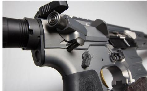
WITH THE TAKE-DOWN PIN PUSHED OUT FROM LEFT TO RIGHT, PIVOT THE REAR OF THE UPPER RECEIVER UP AND AWAY FROM THE LOWER RECEIVER.
