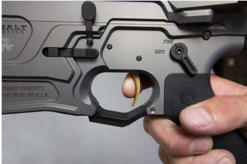
INSERT AN EMPTY MAGAZINE INTO THE MAGAZINE WELL, CHECKING THAT THE MAGAZINE CATCH POSITIVLEY ENGAGES AND LOCKS THE MAGAZINE INTO POSITION.
