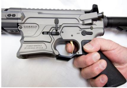
ROTATE THE SELECTOR TO THE "FIRE" POSITION AND PULL THE TRIGGER. YOU SHOULD FEEL MOVEMENT IN THE TRIGGER AND HEAR THE HAMMER FALL.
